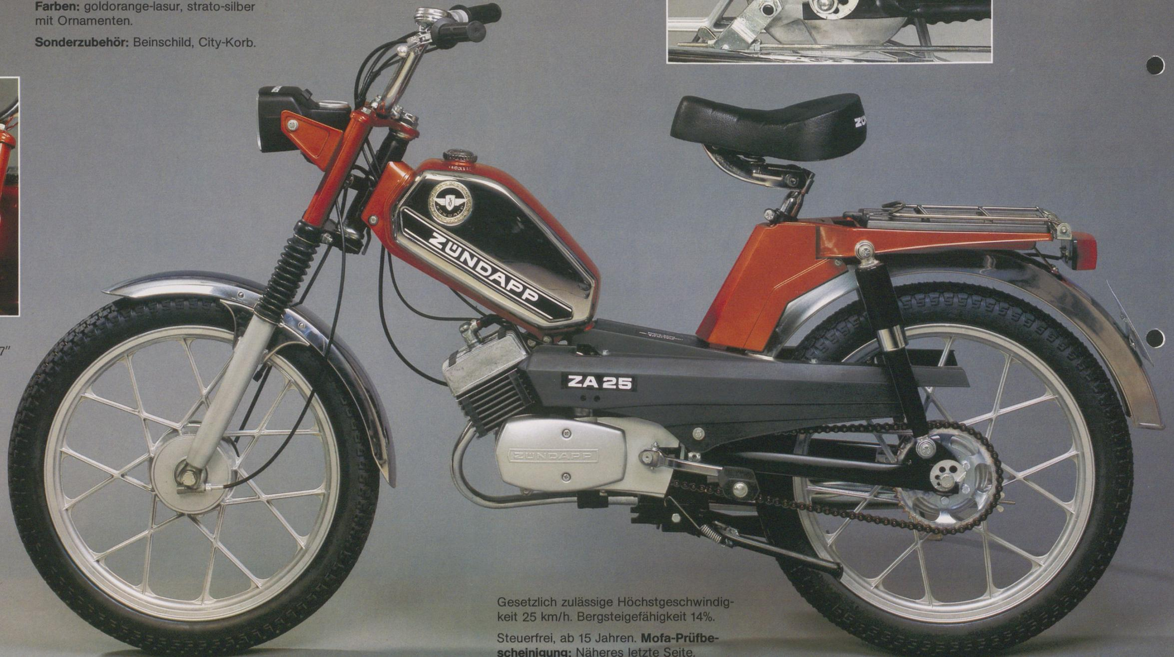
● wartungsfreie, unverwüstliche Alu-Druckguß-Laufräder. Bereifung 2 $\frac{1}{4}$ -17" Moped, damit erhöhte Tragfähigkeit und verstärkte Bodenhaftung für optimale Fahrsicherheit.
