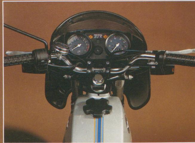
**Serienmäßige Ausstattung:** sportliche 2-Mann-Stufen-Sitzbank mit elegantem Heckspoiler; Doppel-Cockpit mit Tachometer und Drehzahlmesser; Cockpit-Verkleidung; Zündschloß; Lenkschloß; Sicherheits-Bremslicht; Bereifung 2 3/4-17" verstärkt; nichtrostende Edelstahl-Schutzbleche; verchromter Gepäckträger mit Packtaschenhalter.
